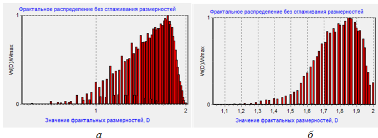
Рис. 2. Фрактальні розподілення зображень мікроструктури гібридного агломерату: а) низ агломераційної чаші; б) середина агломераційної чаші
